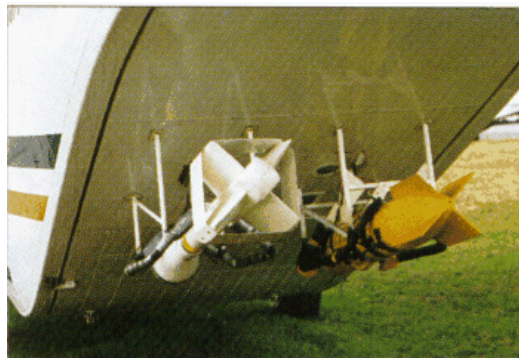
Figura 1.14: GEOTEM (extraído de geoterrex-digihem , 1999)
