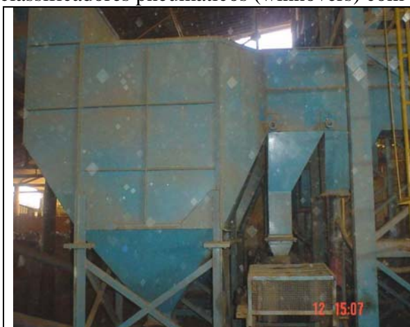
Figura 3.36 - Winnover Médio – para classificação, por tamanho, do concentrado de vermiculita crua.
