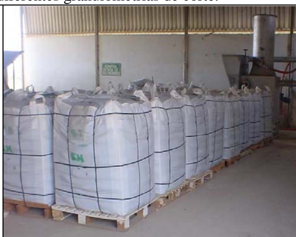
Figura 3.37 - Etapa final – ensacamento dos concentrados de vermiculita crua em “big bags”.
