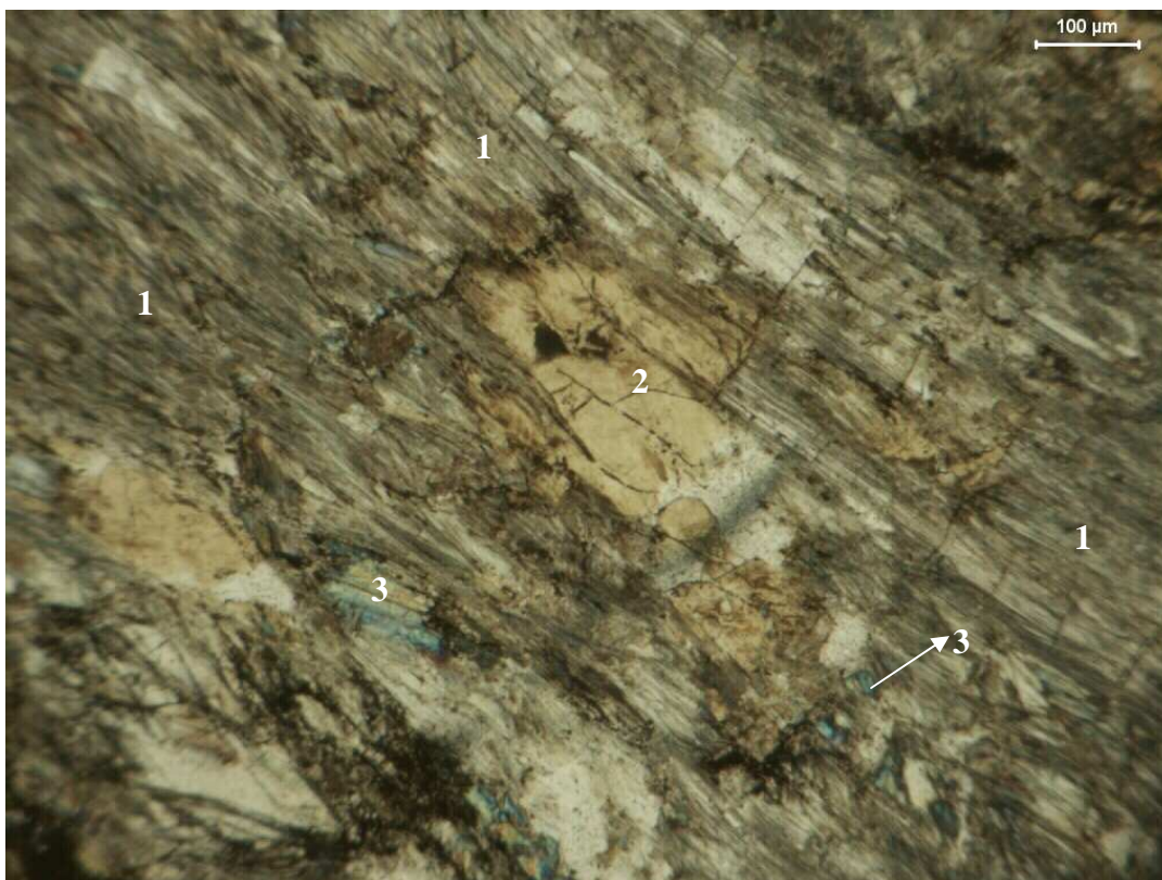
Figura 5.41 - Amostra FS01-17: anfibólios fibrosos (1) transformando-se para vermiculita (2) e talco (3).N X.
