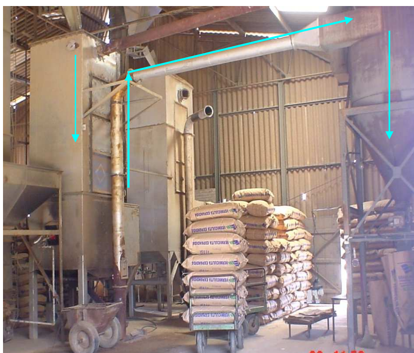
Figura 3.39 - Forno de expansão à esquerda, vermiculita expandida ensacada e ciclone à direita.
