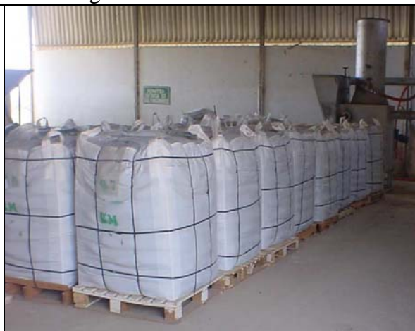
Figura 3.37 - Etapa final – ensacamento dos concentrados de vermiculita crua em “big bags”.
