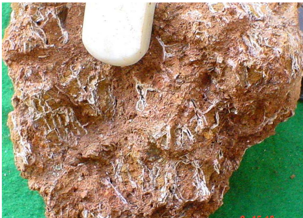
Figura 3.5 - Estrutura de “box work”, provavelmente de sílica em estágio adiantado de formação do solo.
