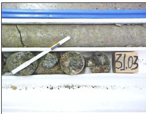
Figura 3.27 - Detalhe do final do furo SR-01, aos 31,03m (inclinado 60°), ainda mineralizado.
