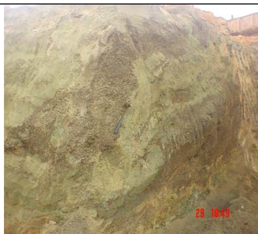
Figura 5.33 - Frente de lavra do Piroxenito hidrotermalizado mineralizado alterado.
