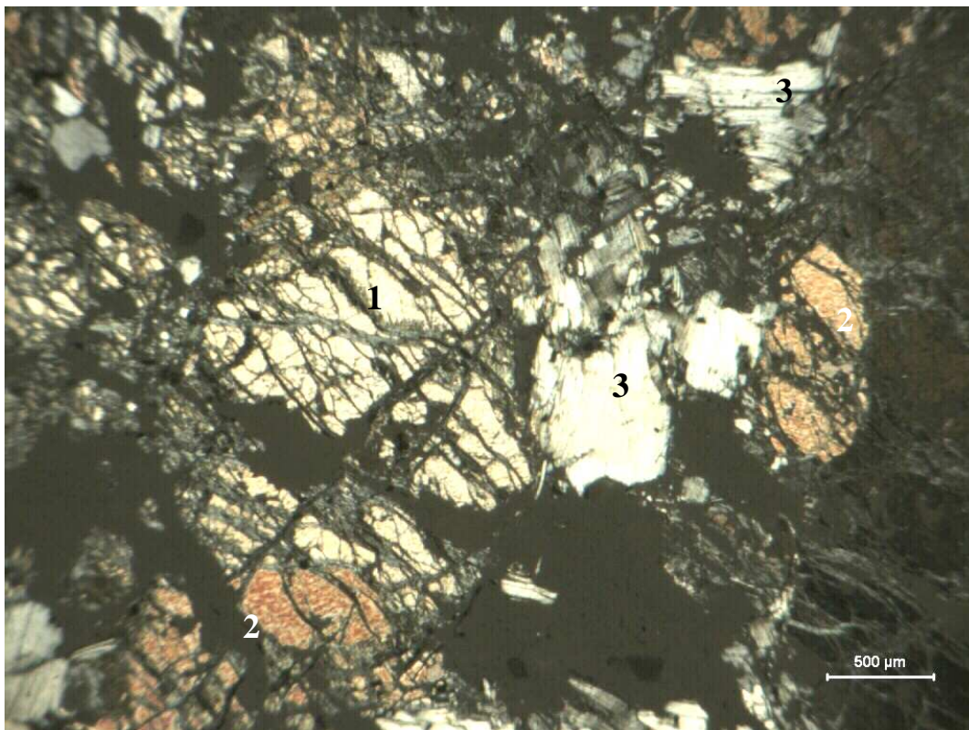
Figura 5.52 - Amostra CIII-40: piroxênio (ortopiroxênio) (1) fraturado associado a anfibólio (2) e talco (3). N X.
