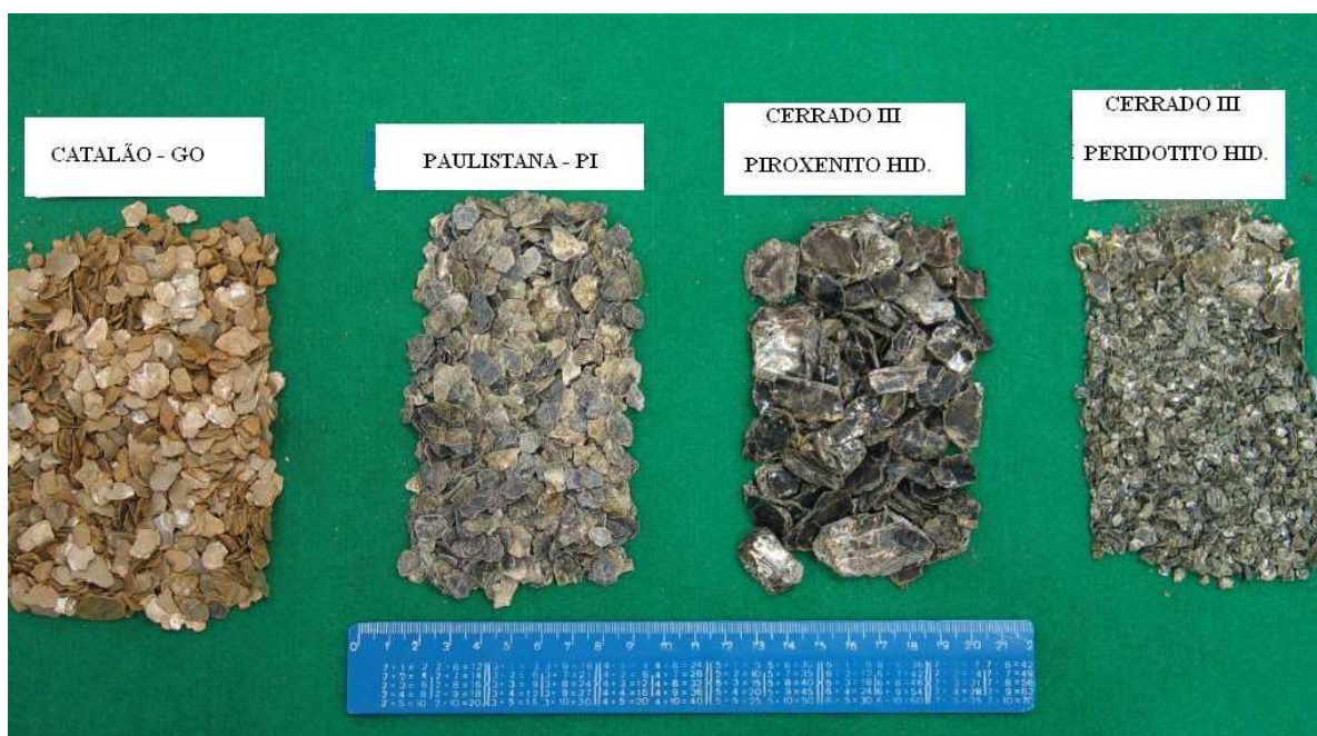
Figura 5.22 - Vermiculitas de diferentes depósitos brasileiros.
