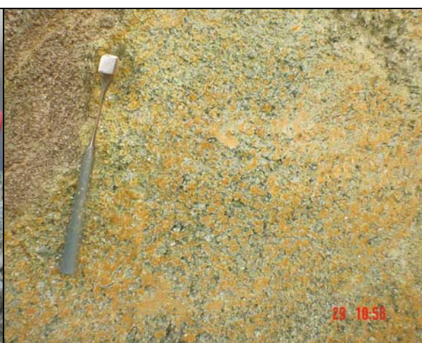
Figura 5.49 – peridotito mineralizado mais alterado na frente de lavra.
