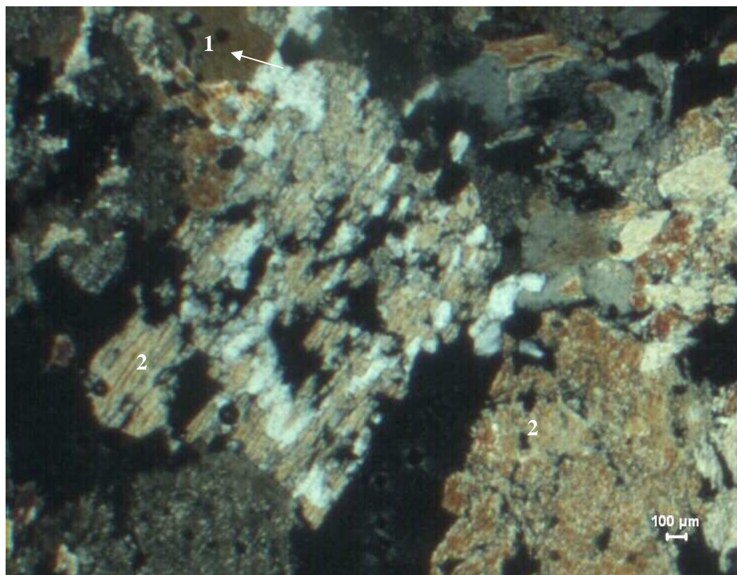
Figura 5.36 - CIII - 24: Piroxênio (1) (baixa birrefringência) quase totalmente alterado para anfibólio (2). N X.
