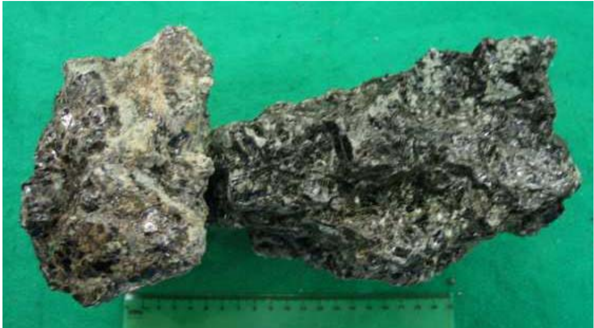
Figura 5.19 - Piroxenito hidrotermalizado mineralizado, com palhetas pegmatóides anômalas.
