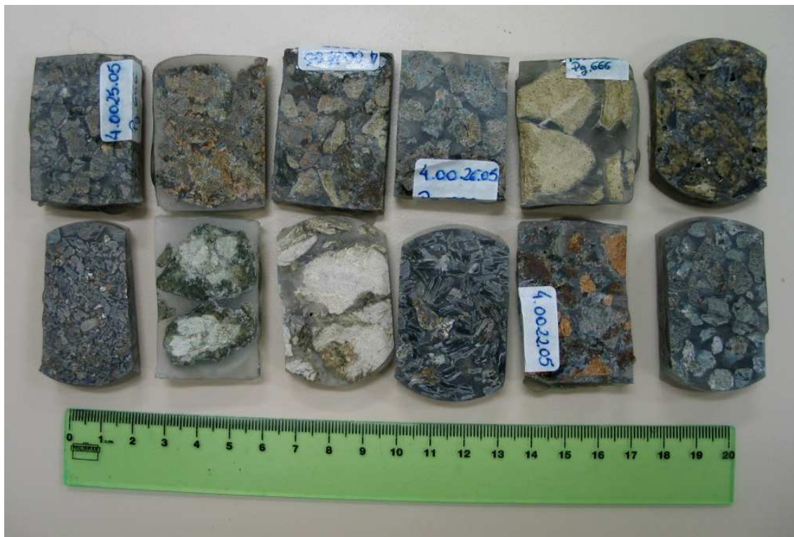
Figura 4.2 - Briquetes das contra-provas das lâminas delgadas.
