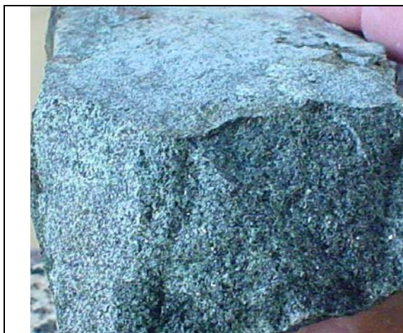
Figura 5.32 - Amostra-de-mão do Piroxenito hidrotermalizado estéril fresco.
